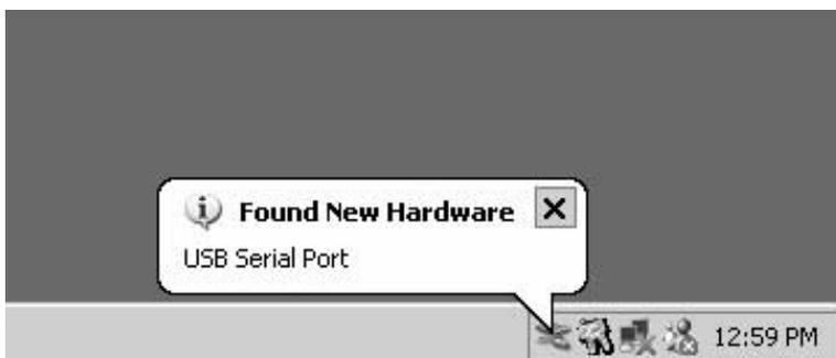
> Dopo l'operazione di installazione, Windows XP riconosce il nuovo hardware collegato: «USB Serial Port» (Porta COM virtuale).
