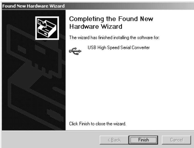
● Instalados todos los controladores de la instalación automática, finalizar el procedimiento de instalación, pulsando el botón [FINISH].
