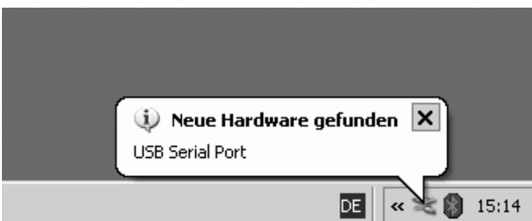
> Nach Abschluss des Installationsvorganges erkennt Windows XP die neue, angeschlossene Hardware: „USB Serial Port“ (Virtueller COM Port).
