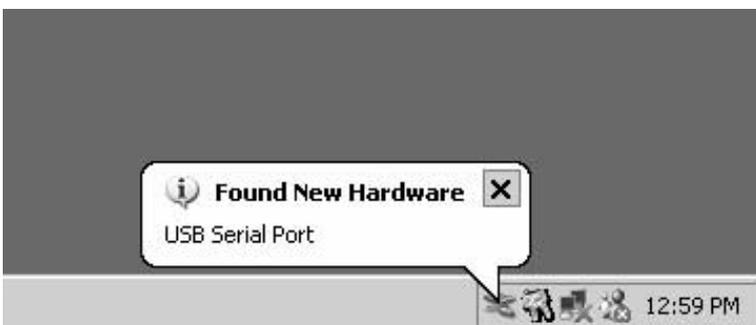
> Finalizado el procedimiento de instalación, Windows XP reconoce el nuevo hardware conectado: "USB Serial Port" (puerto COM virtual).
